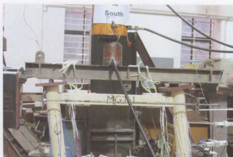
3-2 榫卯节点拟静力试验
