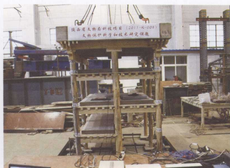
3-4 多层木结构古建筑地震 模拟振动台试验
