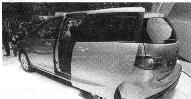
图 1-8 水平移动式车门
