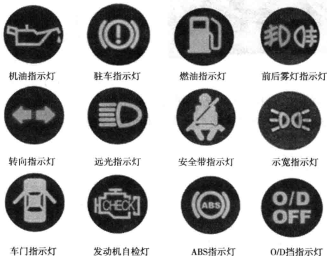
图 1-13 仪表板上的指示灯
