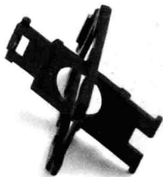
图 1-8 笔记本电脑键盘内部的 X 形弹片
