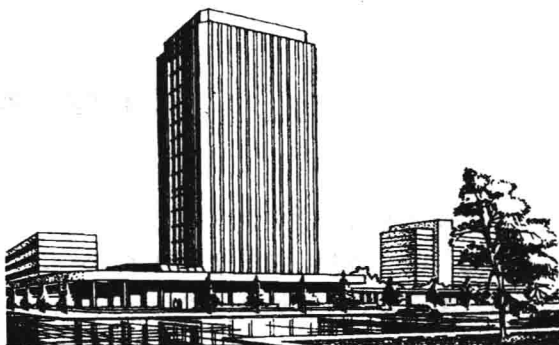
图 1-3 用中心投影法绘制的图样
