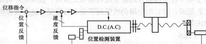
图 1-6 半闭环控制数控机床的工作原理
