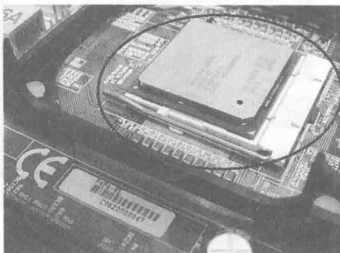
图 1-15 将 CPU 从插座上取下
