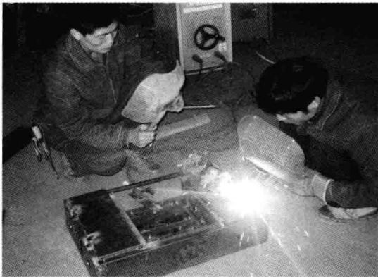
图 1-2 物理性危险——焊接所产生的强紫外线
