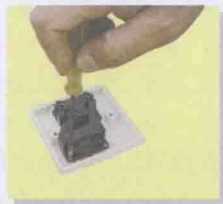
图 1-7 小螺钉旋具的使用方法
