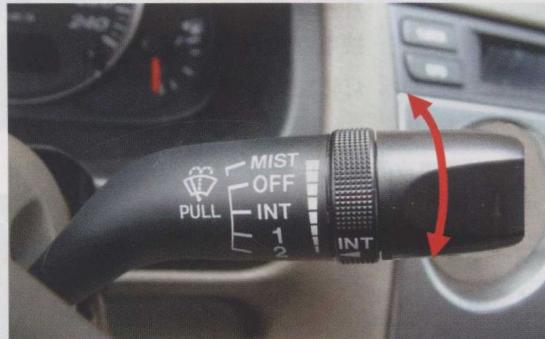
向下拨方向盘右侧刮水器控制手柄，开启前挡风车窗玻璃的刮水器，依照雨水量大小，可选择不同刮水速度
