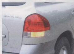
向上推灯光控制手柄, 车辆右侧(前后)转向灯闪烁, 车辆发出向右转向行驶信号
