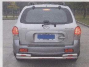
车辆变速器控制杆被推入倒车档位 R 时，车尾倒车照明灯亮。→
