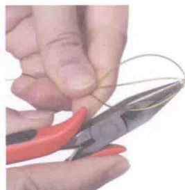
4. 将铁丝的一头用尖嘴钳压紧，以防勾破丝网。
