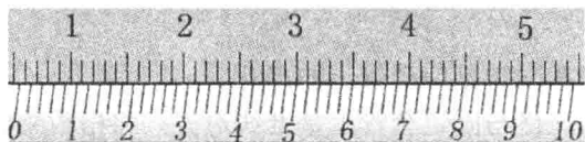
图 1.1-4 测量精度为 0.02 mm 游标卡尺的读数
