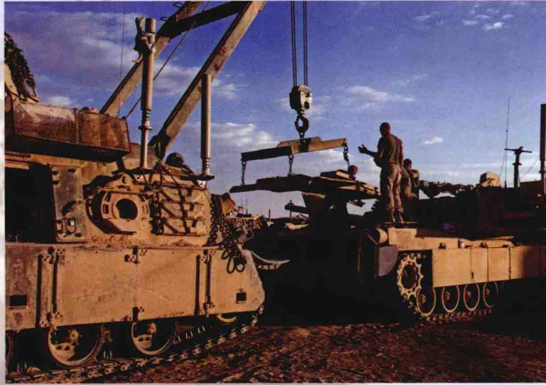
正在吊装发动机的M1A1
