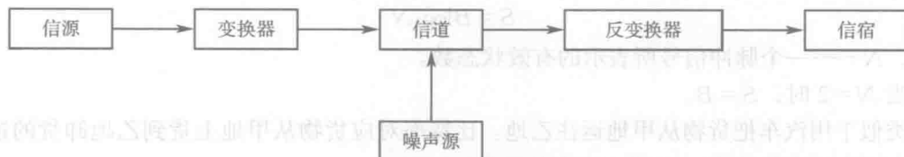
图 2-2 数据通信系统的模型
