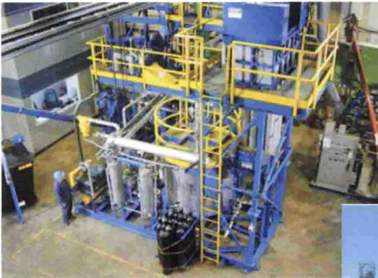
图 10 Dynamotive's 生物质流化床快速热解设备（加拿大）
