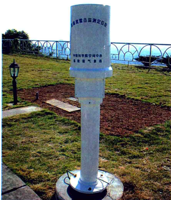
覆盖全省和台湾海峡的雷电监测定位仪
