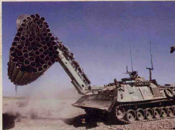
★ 修补道路（填充沟壑）的坦克
