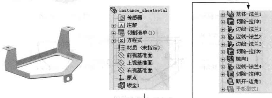
图 2.1 钣金件模型及设计树
