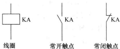
图 1-4 中间继电器的电气符号
