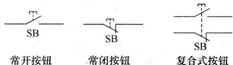
图 1-13 按钮的电气符号
