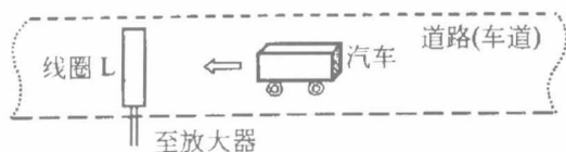
图1 行驶车辆磁感应检测示意图
