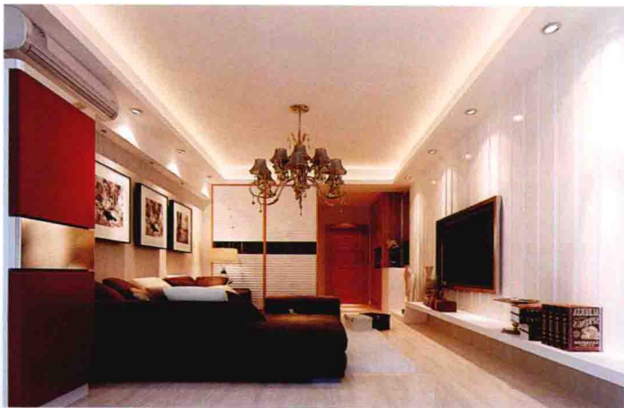
电视墙 [ 杉木板凹凸铺贴刷白 ]
