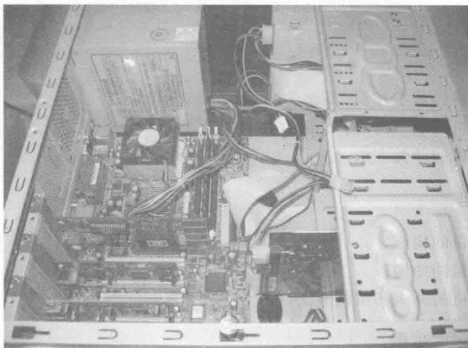
图 1-2 主机箱内部结构
