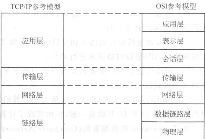
图 1.2 TCP/IP 体系结构模型与 ISO/OSI 体系结构模型
