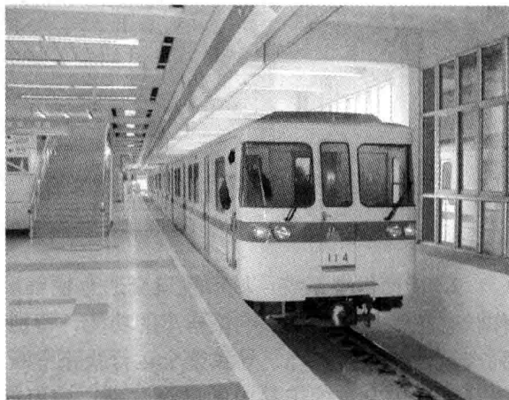
图 1-12 采用直流牵引电动机变速的车辆
