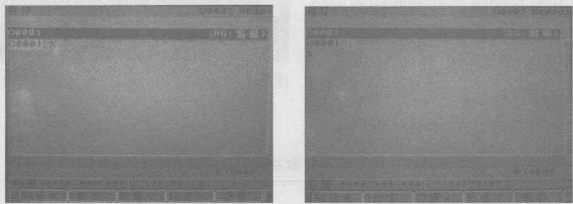
图 1-8 按 [PROG] 键后显示器的界面显示
