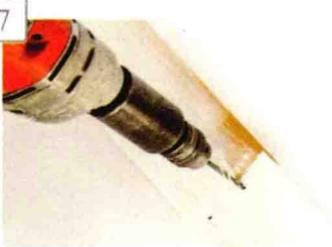
在靠板上打孔。摆放树枝、做标记后打孔。还要在靠板两侧的合适位置上打孔以便安装到墙壁上时使用。
