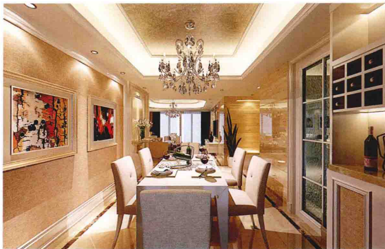
顶面【银箔墙纸+木线条刷白收口】 左墙【墙纸+饰面装饰框刷白】
