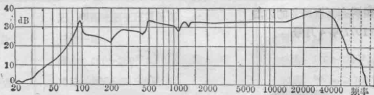
图6 酒石酸钠压电唱头频率特性
