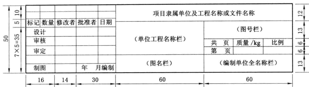
图 1-3 采矿制图标题栏的格式
