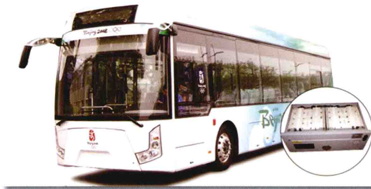
中信国安盟固利动力公司研制的电动汽车用锂离子动力电池 90Ah
