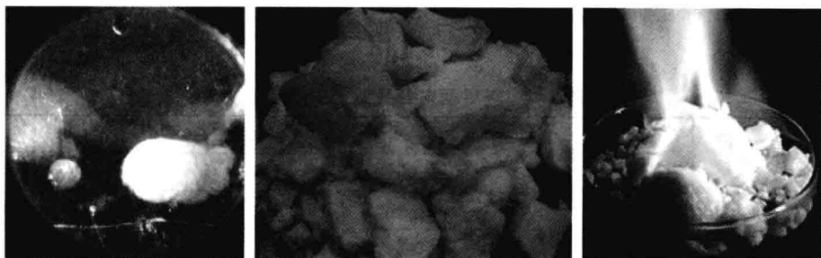
图 1.5 实验室合成的瓦斯水合物样品
