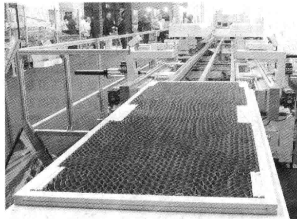
图7 纸板空心门组装加工中心
