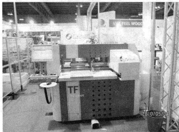
图2 数控小型下钻铣锯加工中心
