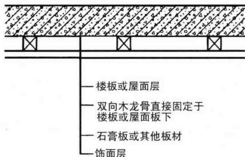
图2.02 直接固定装饰板顶棚
