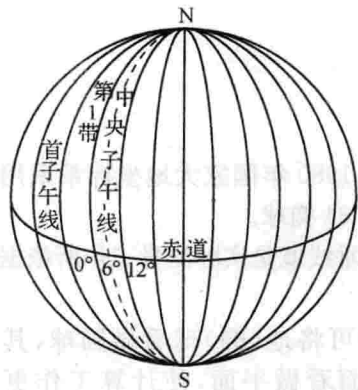
图 0-2 高斯平面直角坐标的分带
