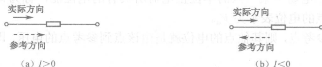
图 1-5 电流实际方向与参考方向的关系
