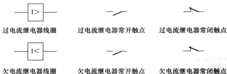
图 1-7 电流继电器的文字和图形符号
