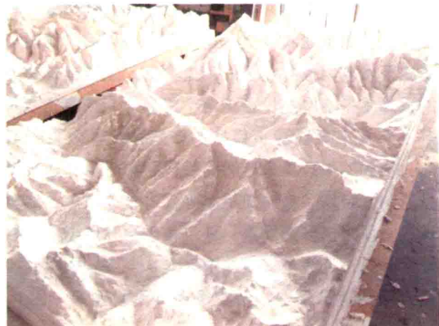
图1-12 石膏与白水泥制作的地形模型（赛悦模型 制作）
