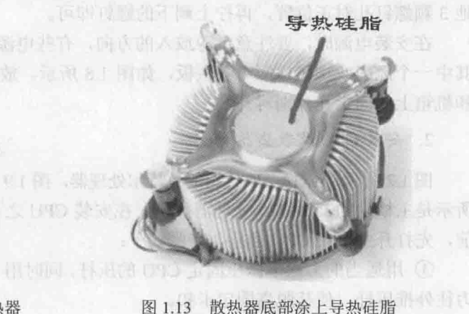
图 1.13 散热器底部涂上导热硅脂
