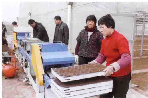
自主研发成功烟种直播机，既提高了播种效率，又提高了播种质量，有效实现了育苗环节的减工降本
