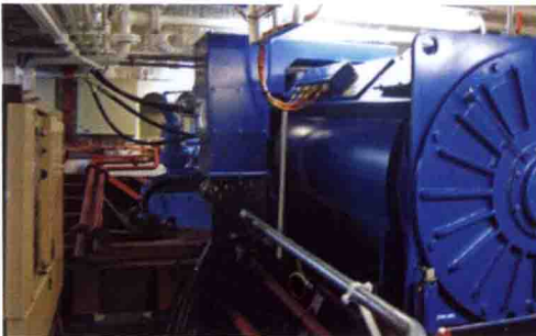
Marelli 2,200 kW水冷双jacked主推进电动机
