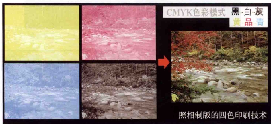
图 0-1-9 四色印刷术原理
