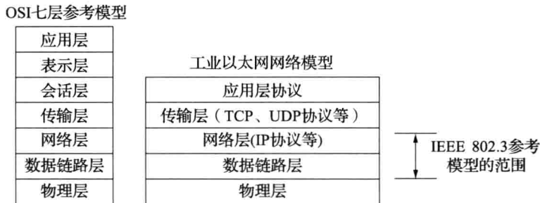
图 10.7 工业以太环网的网络协议模型与 OSI 七层参考模型对比
