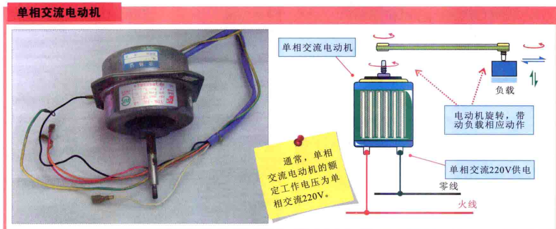
【图1-6 典型单相交流电动机的实物外形和典型应用】
