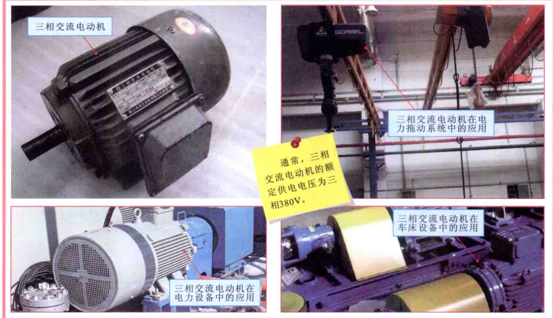
【图1-8 典型三相交流电动机的实物外形和典型应用】
