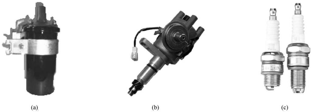
图 1-4 汽车点火电路主要部件
