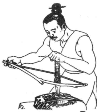
图 0-4 半坡人用弓钻钻孔
