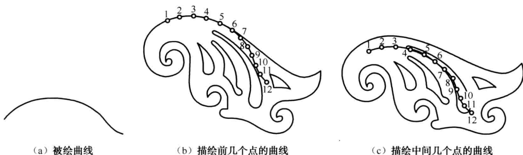
图 1-1-8 曲线板的用法
