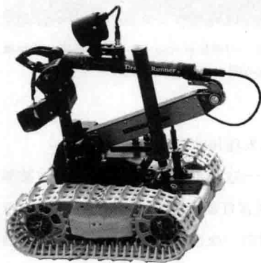
“龙行者”排爆机器人，其上安装有4个照相机，可将图像传给操作者
