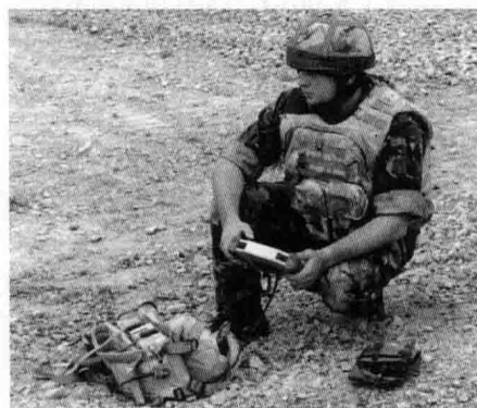
“龙行者”排爆机器人由士兵在安全距离处遥控操作，其控制器类似于游戏控制器
