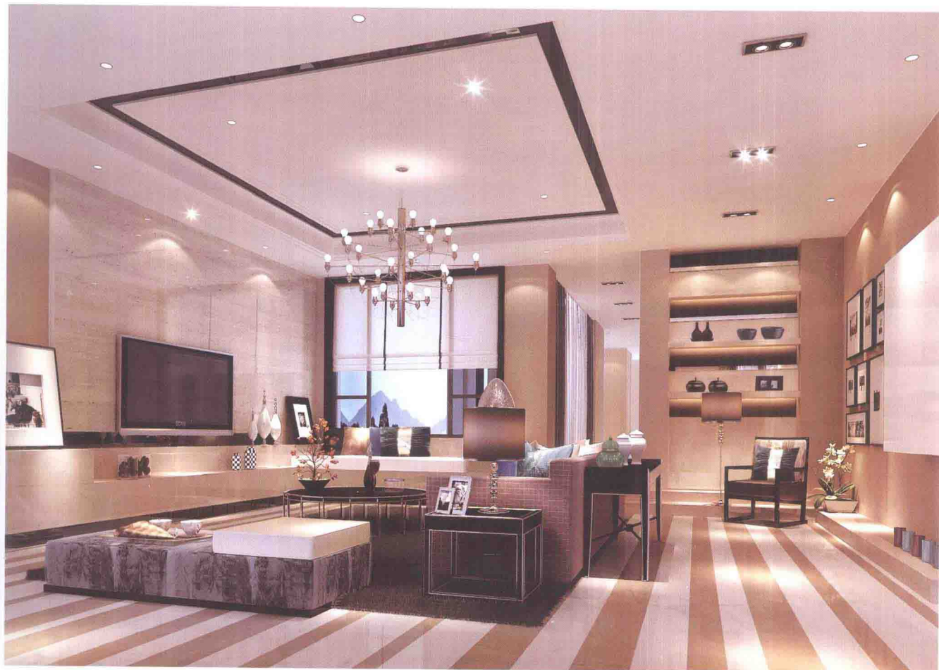
◎顶面 / 石膏板嵌黑镜 电视墙 / 洞石 + 黑镜 + 爵士白大理石 地面 / 双色地砖拼花
