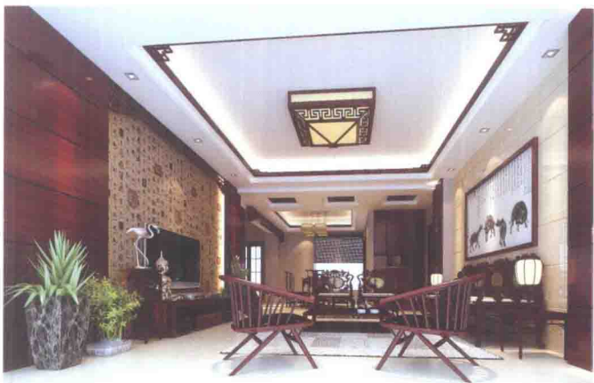
◎顶面 / 实木角花 电视墙 / 书法墙纸 + 木饰面板 沙发墙 / 墙纸
