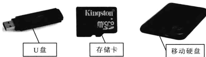
图 1-8 移动存储设备
