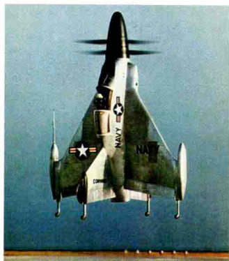
为美国海军研制的XFY-1，采用头朝上的垂直起飞姿态
