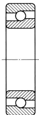
图 1-5 角接触向心球轴承
